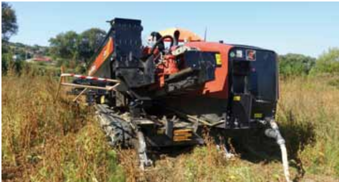
Wiertnica podczas przewiertu pod Sanem. Fot. M. Ulanowska
